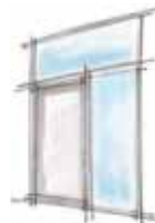
JEDNOSKRZYDŁOWE Z NAŚWIETŁEM GÓRNYM ORAZ BOCZNYM
